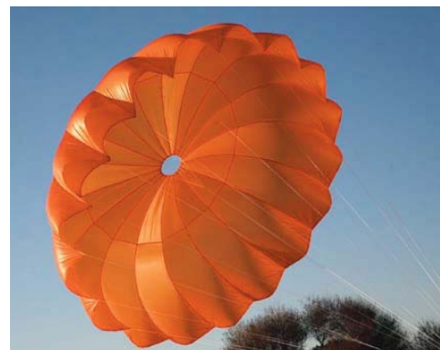
Se trata de un diseño PDA específico como una campana más plana para conseguir una superficie mayor y mejorar la tasa de caída.
